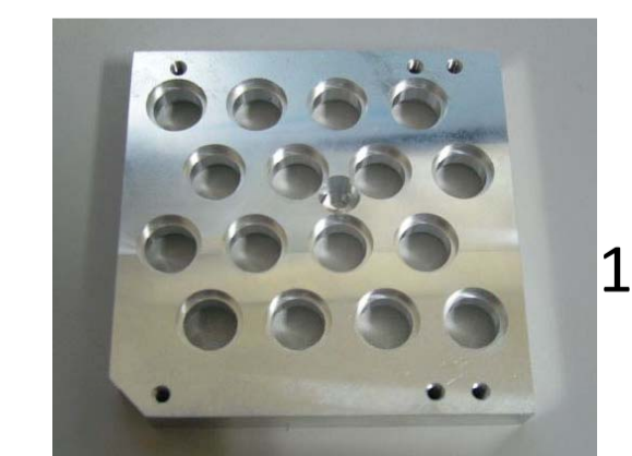
磁石装着型カセット 16個それぞれの穴に磁石が装着されている
