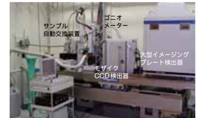
タンパク質構造解析専用ビームラインの一つ、BL26B2のサンプル測定装置
